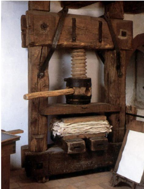
Dieser Stapel wird zum Entwässern in die Presse geschoben. Nach dem Pressen sind die Papiere noch immer leicht feucht, sind nun aber so verdichtet, dass sie sich gut wieder von den Filzen abnehmen lassen.
