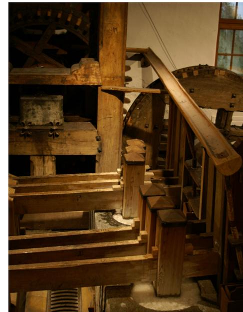
In der Papiermühle wurden die Lumpen nach einem Faulungsprozess, bei dem sie sich schon leicht zersetzten, in die steinernen Behälter des *Stampfwerks* gegeben. Es wurde Wasser dazugeschüttet und das Mühlrad trieb hölzerne Hammer an, die 48 Stunden lang auf dieses Wasser-Lumpengemisch einschlugen. Danach waren die Lumpen zu einem Brei, der *Pulpe*, zerkleinert.
